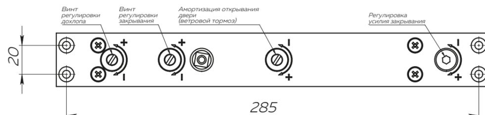
**Функция регулировки усилия закрытия и характеристики доводчика**
