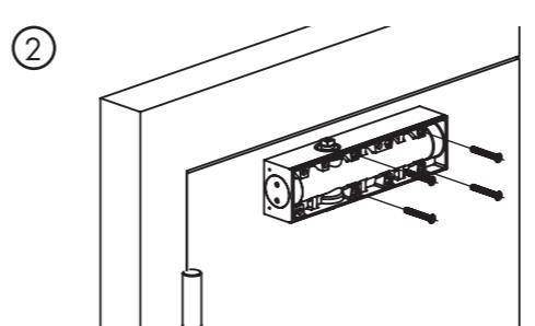
С помостью 4 винтов/саморезов закрепите на дверном полотне или коробке (в зависимости от выбранного варианта установки) корпус доводчика. Регулировочные петли должны быть со стороны петель.
