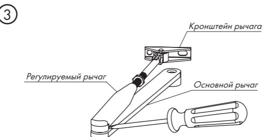
Детали рычажного механизма в комплекте поставки соединены между собой. Необходимо разъединить основной и регулируемый рычаг с помощью плоской отвертки. После зафиксировать кронштейн рычага на дверном полотне или коробке (в зависимости от выбранного варианта).
