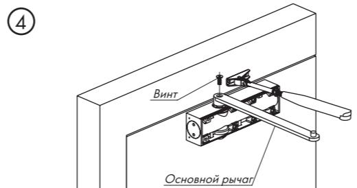
Закрепите на корпусе доводчика основной рычаг с помощью винта.
