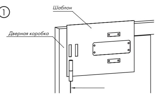
Совместите шаблон максимально точно по контуру дверного полотна/коробки и петель. Закрепите шаблон, например скотчем. Далее необходимо подготовить отверстия для установки доводчика.
