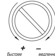
Регулировка производится двумя винтами, которые расположены на торце корпуса доводчика:
