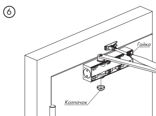
Затяните фиксирующую гайку на рычаге доводчика. Установите колпачок на ось корпуса доводчика с противоположной от рычага стороны.
