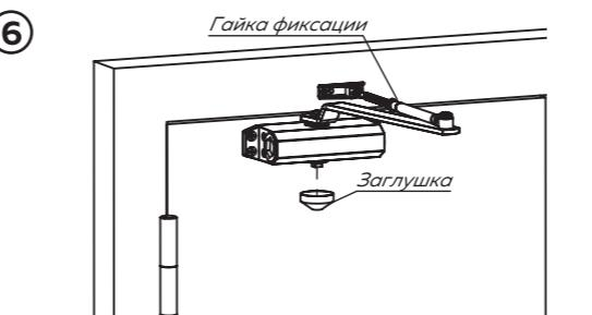
Зафиксируйте фиксирующую гайку на рычаге доводчика. Отверстие под винт, на корпусе с противоположной стороны доводчика, закройте декоративной заглушкой. Далее выполните регулировку доводчика.
