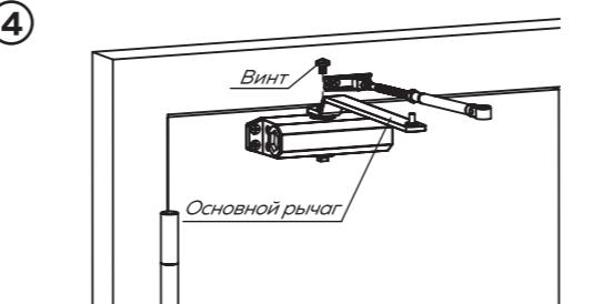
Закрепите на корпусе доводчика основной рычаг с помощью винта.
