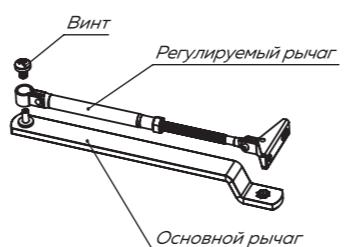
Детали рычажного механизма в комплекте поставки соединены между собой. Необходимо разъединить основной и регулируемый рычаг. После зафиксировать кронштейн рычага на дверном полотне или коробке (в зависимости от выбранного варианта).
