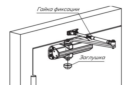
Зафиксируйте фиксирующую гайку на рычаге доводчика. Отверстие под винт, на корпусе с противоположной стороны доводчика, закройте декоративной заглушкой. Далее выполните регулировку доводчика.
