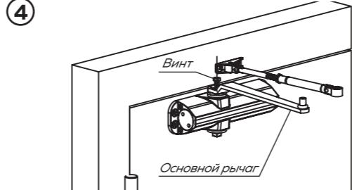
Закрепите на корпусе доводчика основной рычаг с помощью винта.
