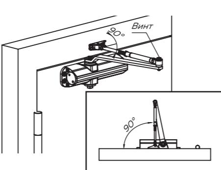
Выставьте длину регулируемого рычага, проворачивая винтовую часть по или против часовой стрелки. Установите и зафиксируйте соединительный винт.
