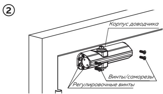
С помощью 4-х винтов/саморезов закрепите на дверном полотне или коробке (в зависимости от выбранного варианта установки) корпус доводчика. Регулировочные винты должны быть расположены со стороны петель.
