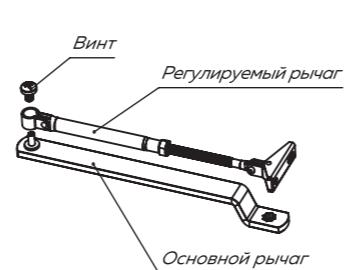
Детали рычажного механизма в комплекте поставки соединены между собой. Необходимо разъединить основной и регулируемый рычаг. После зафиксировать кронштейн рычага на дверном полотне или коробке (в зависимости от выбранного варианта).
