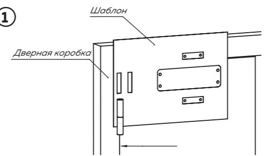
Совместите шаблон максимально точно по контуру дверного полотна/коробки и петель. Закрепите шаблон, например скотчем. Далее необходимо подготовить отверстия для установки доводчика.
