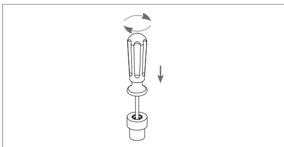
2. Вставить резьбовую шпильку в основание дверного упора.
