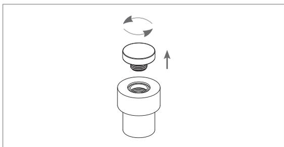
3. С помощью отвертки зафиксировать резьбовую шпильку в дюбеле в предварительно подготовленном отверстии на полу.
