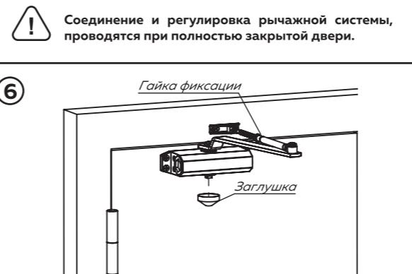
Зафиксируйте фиксирующую гайку на рычаге доводчика. Отверстие под винт, на корпусе с противоположной стороны доводчика, закройте декоративной заглушкой. Далее выполните регулировку доводчика.
