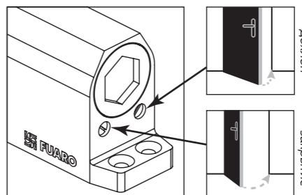
Закрытие дверного полотна в двух зонах регулируется винтами на корпусе доводчика:
