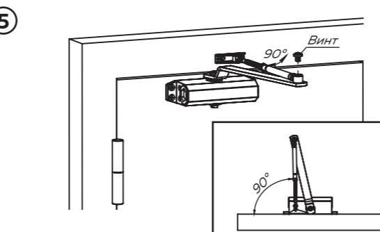
Выставьте длину регулируемого рычага, проворачивая винтовую часть по или против часовой стрелки. Установите и зафиксируйте соединительный винт.
