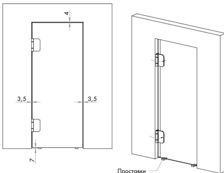
7. Зафиксировать стекло на петлях через втулки (7). Установить крышки (4), предварительно сняв защитную плёнку со скотча (6).
