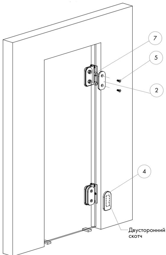
8. Установить крышки (3), предварительно сняв защитную плёнку со скотча (6).
