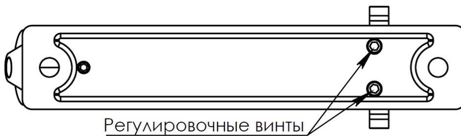
На чертеже активная створка находится справа, при левой активной створке использовать зеркальное отражение чертежа, при этом необходимо выкрутить ролик и вкрутить его в соседнее отверстие (см. рисунок ниже).
